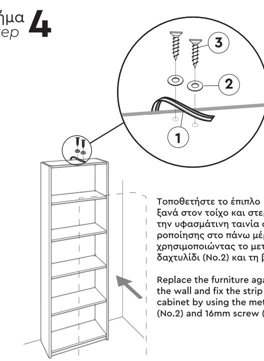
Τοποθετήστε το έπιπλο ξανά στον τοίχο και στερεώστε την υφασμάτινη τανία σταθεροποίησης στο πάνω μέρος του χρησιμοποιώντας το μεταλλικό δαχτυλίδι (No.2) και τη βίδα (No.3).
